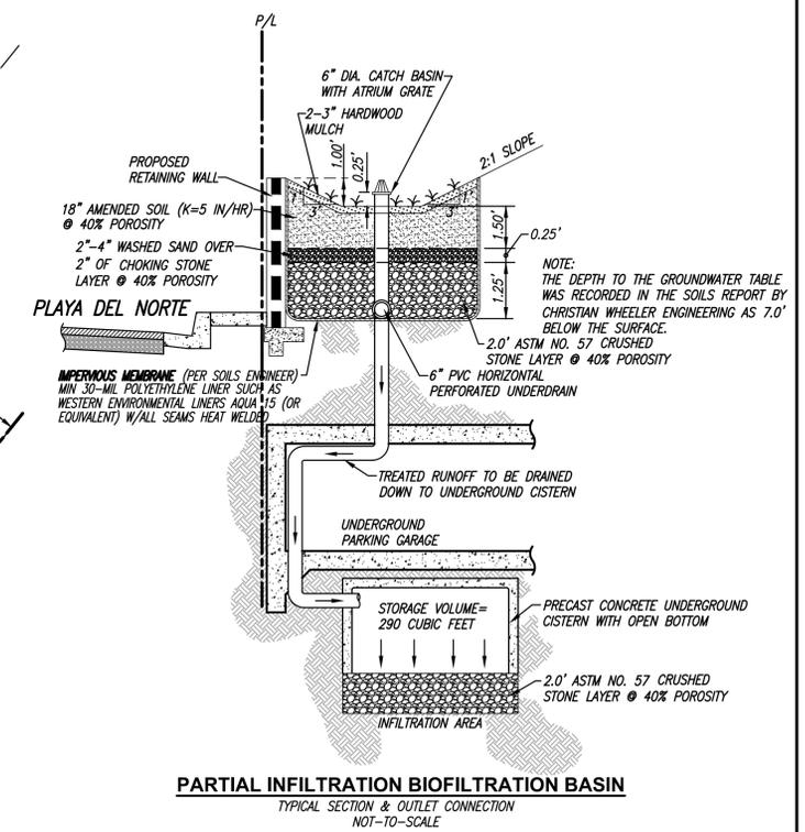
**PARTIAL INFILTRATION BIOFILTRATION BASIN MEDIA**
